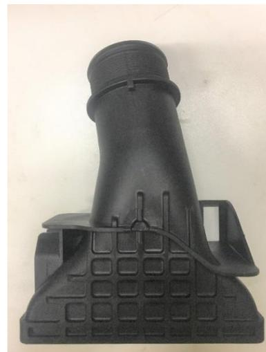
Figura 15 - Peça injetada de PA666 (automóvel de passageiros)
