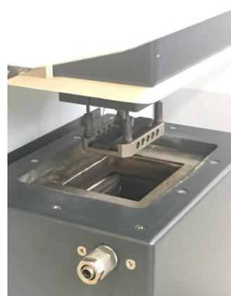
Figura 26 - Aparelho utilizado para os ensaios de DMA 242 D da NETZSCH Leading Thermal Analysis
